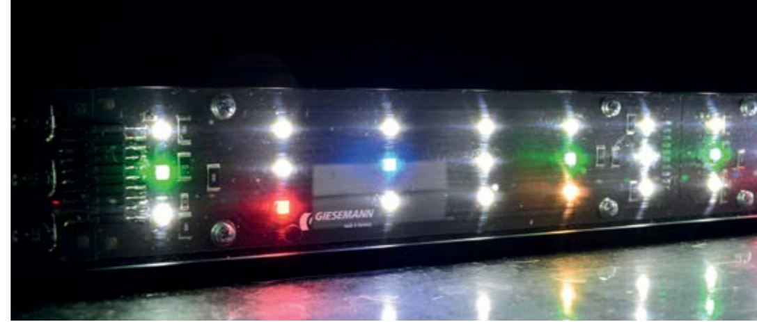
Bei der Giesemann PULZAR HO dim werden zwei verschiedene Weißlicht-LEDs und drei Farb-LEDs (Rot, Grün, Blau) verbaut Foto: P. Fitz
