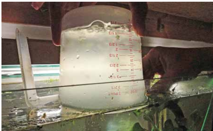
Auslitern der Luftmenge, die der Luftheber liefert
