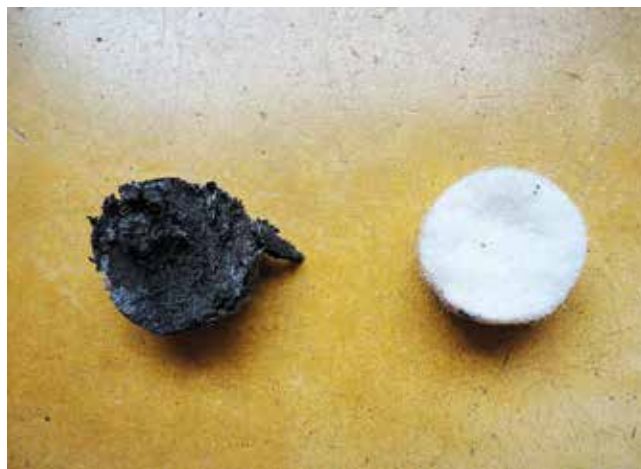
Ein über 13 Monate gebrauchter und ein neuer Luftfilter der APS 300
