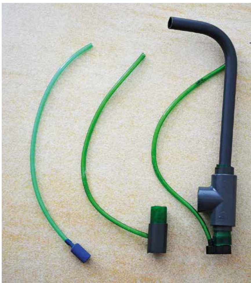
Variation des Lufteinlasses bei einem modifizierten GN-Luftheber
