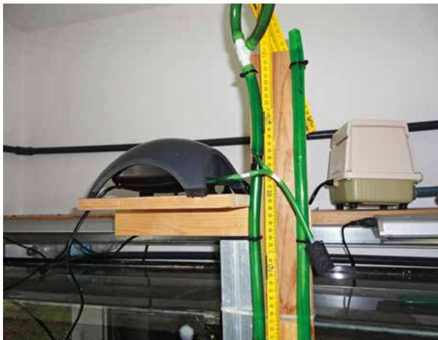
Anordnung für die Messung des Druckabfalls typischer Bauteile einer Luftversorgung (Luftquelle: APS 300; Verbraucher: Ausströmerstein AS 35, beides von Tetra, gemessen mit Acht-Zentimeter-Messleitung)
