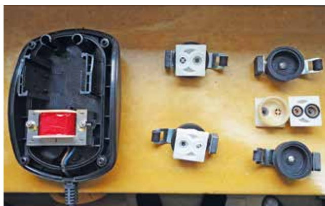
APS 300 mit ausgebauten alten (rechts) und neuen Membranen (links)
