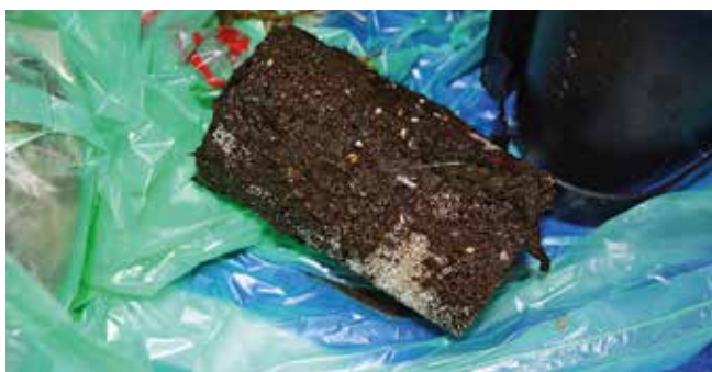
Filterpatrone nach dreistündigem Einsatz
