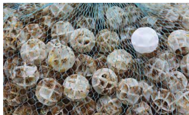
BalanceBalls neu (auf dem Netz) und nach sieben Wochen Einsatz im Biofilter (im Netz)
