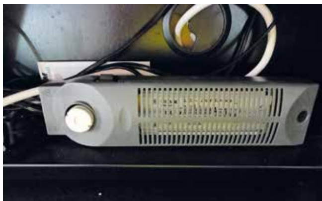
Arcadia-Vorschaltgerät (KVG). KVG- und VVG-Lichteinheiten erkennt man am Starter.
