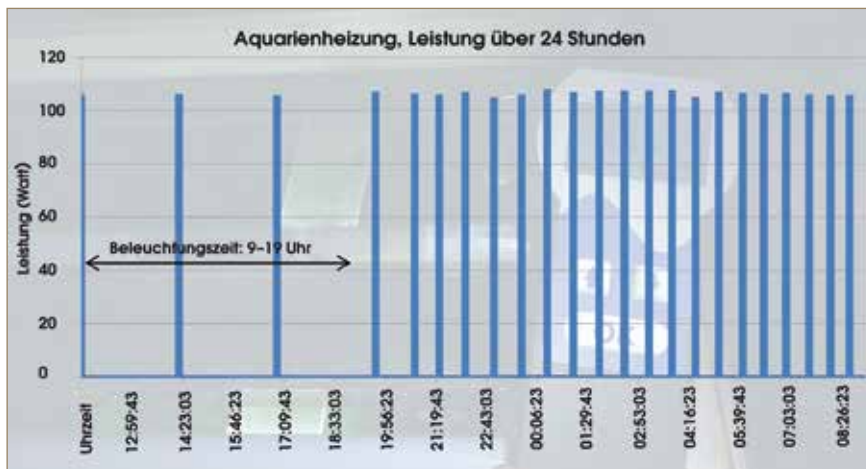
Strombedarf des Heizers über 24 Stunden Abbildungen (wenn nicht anders vermerkt): Petra Fitz
