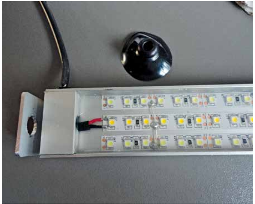
LED-Balken mit fester Lichtfarbe (cool-warm-cool) von der Firma Lumlight
